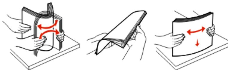
4 図に示すように、用紙の束は、推奨される印刷面を下にしてカセットの背面の方にセットします。
